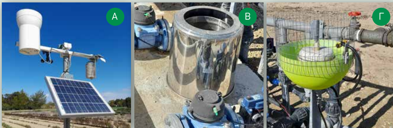
Εικόνα 1. Έλεγχος κλιματικών δεδομένων (Α), αυτόματο εξατμισόμετρο (Β), έξυπνη συσκευή άρδευσης (Γ).
